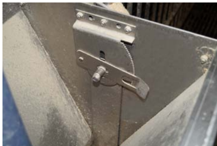
Justeringssystemet kræver kun 2 justeringer pr. Foderautomat, hvilket giver en hurtig, præcis og konsekvent kontrol af foder indstillinger.
