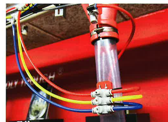
Tydelige farver på luftslangerne gør det nemt at huske, hvilken foderblanding der skal tildeles eller allerede fodres med i den enkelte sti. Der kan også fodres med samme blanding på sektionniveau.
