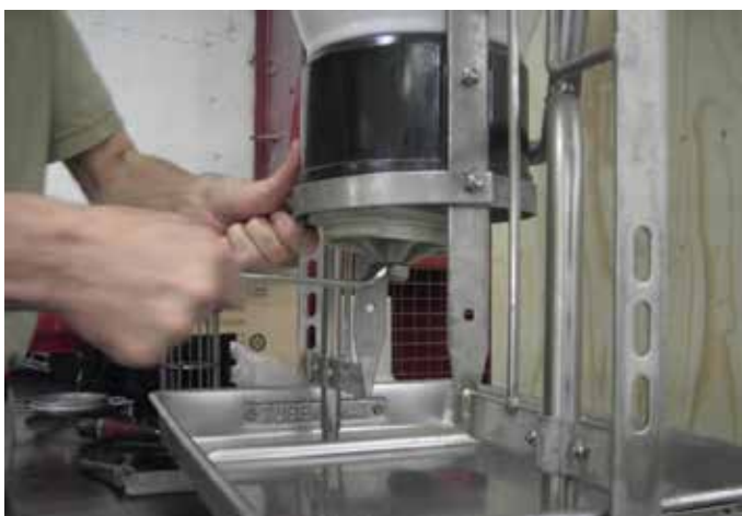
8 mm låsemøtrik afmonteres og foderrondel drejes af (mod venstre).
