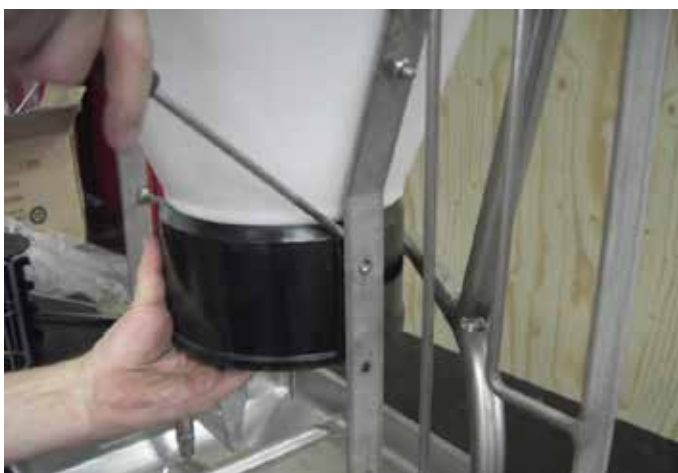
8 mm møtrik fjernes og bolte skubbes ind. Herefter frigøres kraven som vist med en stor lige-kærveskruerækker, alternativt ved at slå boltene gennem rammen med hammer og dorn.
