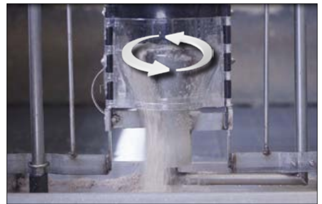
Truget fyldes automatisk med foder, når sensoren melder tom
