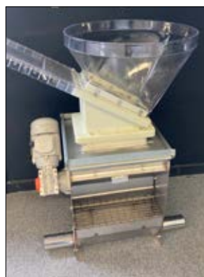
Optagerstation i rustfrit eller galvaniseret stål.
