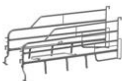
Farelad XL standard, med vippebøjle L1 (inkl. baglåde): 2400 mm } + 50 el. L2 (inkl. baglåde): 1975 mm } 100 mm
