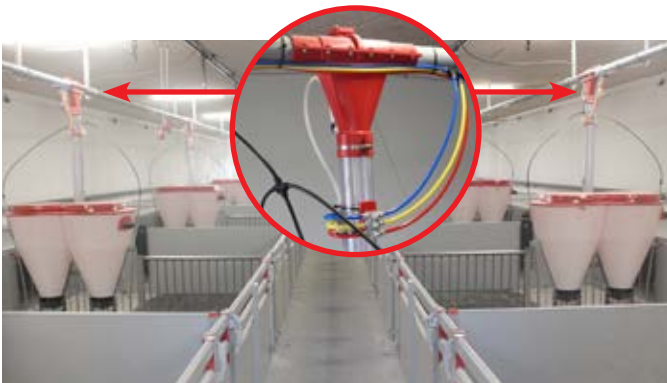
COLOR FEED SINGLE: Fasefodringsventil i smågrisestald
