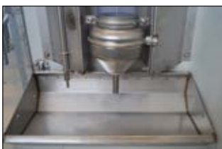
▲ Foderautomat med pendul til fodring af de fravænnede grise
