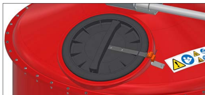
Hvis lugen er placeret med grebet vendende lodret, monteres beslaget til safety switch vinkelret på grebet på lugen
