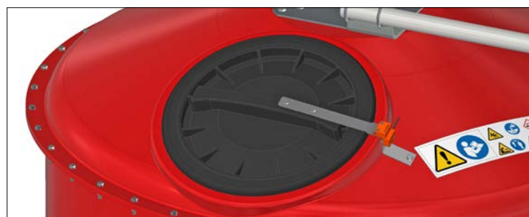
Hvis lugen er placeret med grebet vendende i horisontal retning, monteres beslaget til safety switch på grebet på lugen
